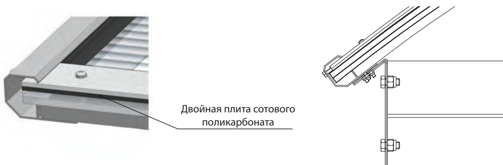
Сечение зенитного фонаря с заполнением двойной плитой сотового поликарбоната
